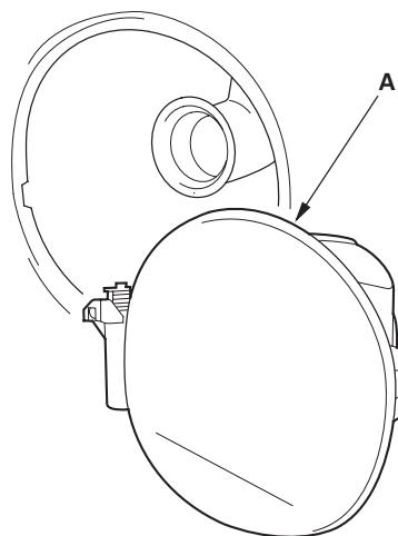
5. 按照与拆卸相反的顺序，安装燃油加注口门 / 适配器，并确保适配器唇口 (A) 完全固定在燃油加注管 (B) 上。
