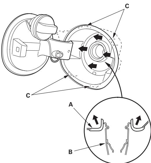
4. 将燃油加注口门 / 适配器 (A) 从车身上拆下。
